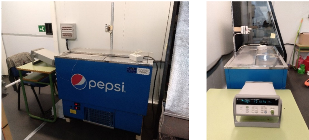
Figura 2. Equipo analizado colocado en la cámara climática con el sistema de adquisición utilizado
